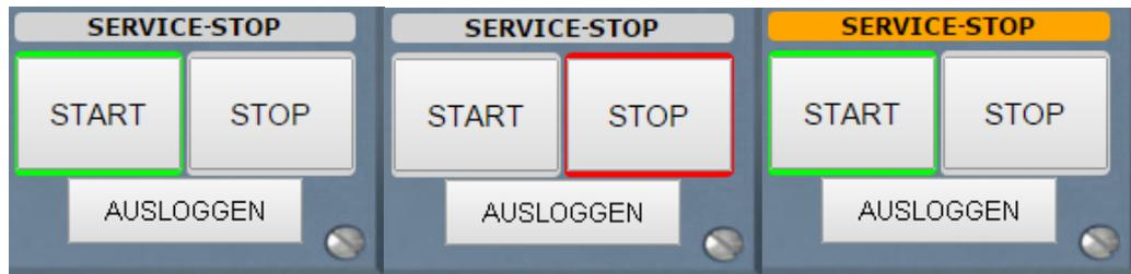
Die letzte Taste dieser Sektion ist "AUSLOGGEN". Nach Nutzungsschluss durch drücken der Taste "AUSLOGGEN" wird das sichere Verlassen des Systems durchgeführt. Das System schaltet nach 15-minütiger Nutzungs-Ruhe eine Meldung über die automatische Abschaltung ein. Wird die Anzeige nicht durch den Klick auf „Sitzung verlängern“ gelöscht, schaltet sich das System selbst aus.
